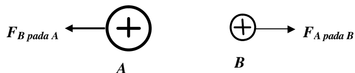
Gambar 19 Titik B berada di dalam daerah medan listrik yang disebabkan oleh benda bermuatan A .
