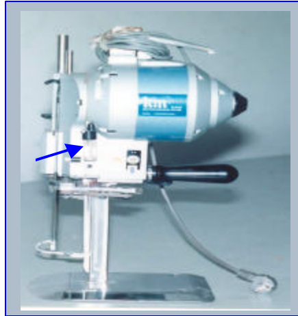
Gambar: 2.4. Cara Meminyaki Mesin Potong
