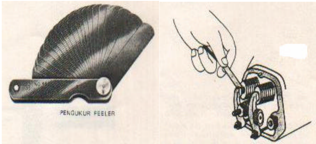
Gambar 5. Feeler (Sumber : Yanmar)
