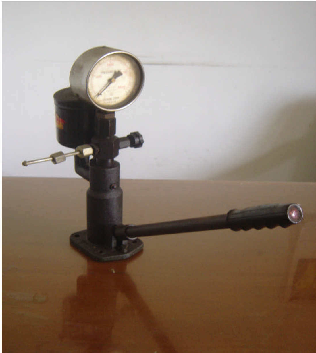
Gambar 8. Alat pengetes nozel dan bentuk pengabutan nozel
