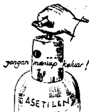
Gambar 1.7: Membuka keran botol asetilin harus setelah regulator terpasang
